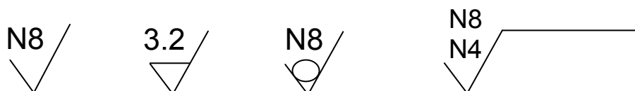
Слика 2.5. Симболи за означување на квалитет на површинска обработка
