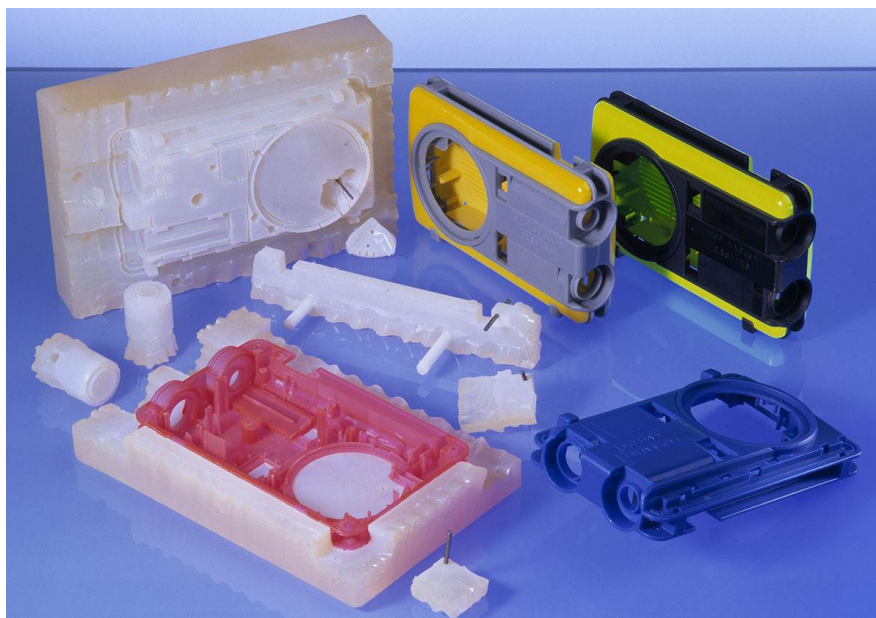
Слика 3.20: Делови добиени со вакуумско леење од силиконски алат добиен со индиректна изработка (Извор: [108])
