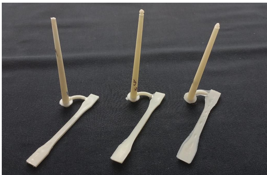
Слика 5.35: Прогресивно зголемување на венецот кај изработените модели. Број на примероци на сликата од лево на десно: 1, 33, 50 (Извор: Сопствено истражување)
