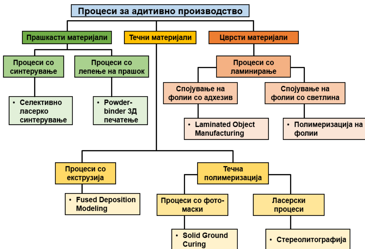
Слика 3.2: Класификација на процесите за адитивно производство (Извор: [55])
