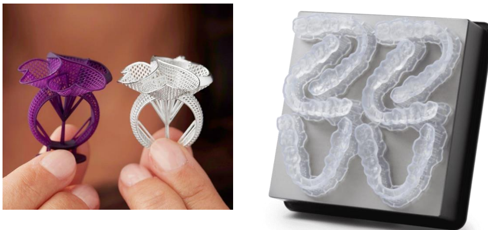
Слика 3.3: Примери за директна примена на делови изработени со SLA технологијата (Извор: [57])
