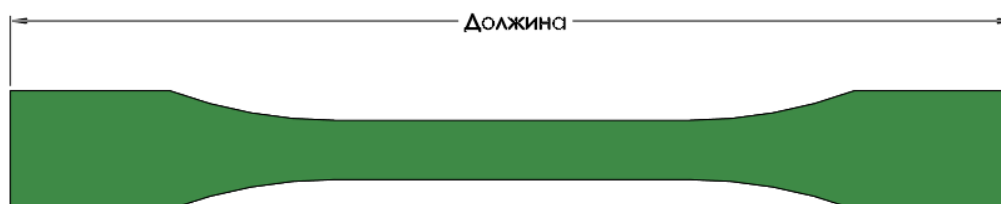
Слика 5.55: Ознака за контролираната должина кај моделот (Извор: Сопствено истражување)
