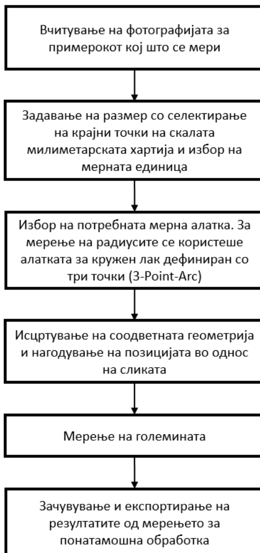
Слика 4.14: Блок-дијаграм на постапката за добивање на мерките на радиуси (Извор: Сопствено истражување)
