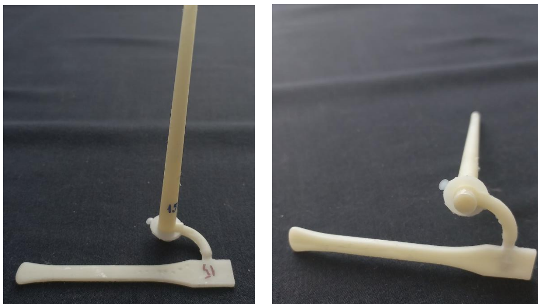
Слика 5.36: Пример од примероците (11 до 16) кои не се земени предвид за статистичка анализа поради нецелосно исполнување на гравурата (Извор: Сопствено истражување)
