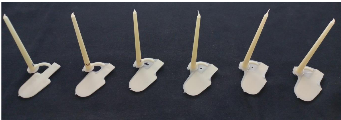
Слика 5.38: Прогресивно зголемување на венецот кај изработените делови. Број на примероци на сликата од лево на десно: 1, 10, 19, 26, 38, 48 (Извор: Сопствено истражување)
