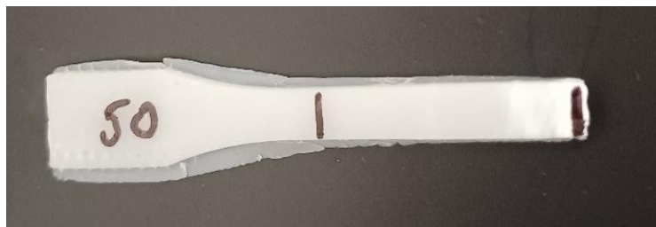
Слика 5.57: Широчина на формираните венец во близина на мерното подрачје на епруветата (Извор: Сопствено истражување)
