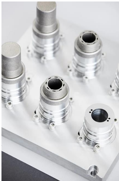
Слика 3.21: Хибриден вметок со конформални канали добиен со SLS (Извор: [113])
